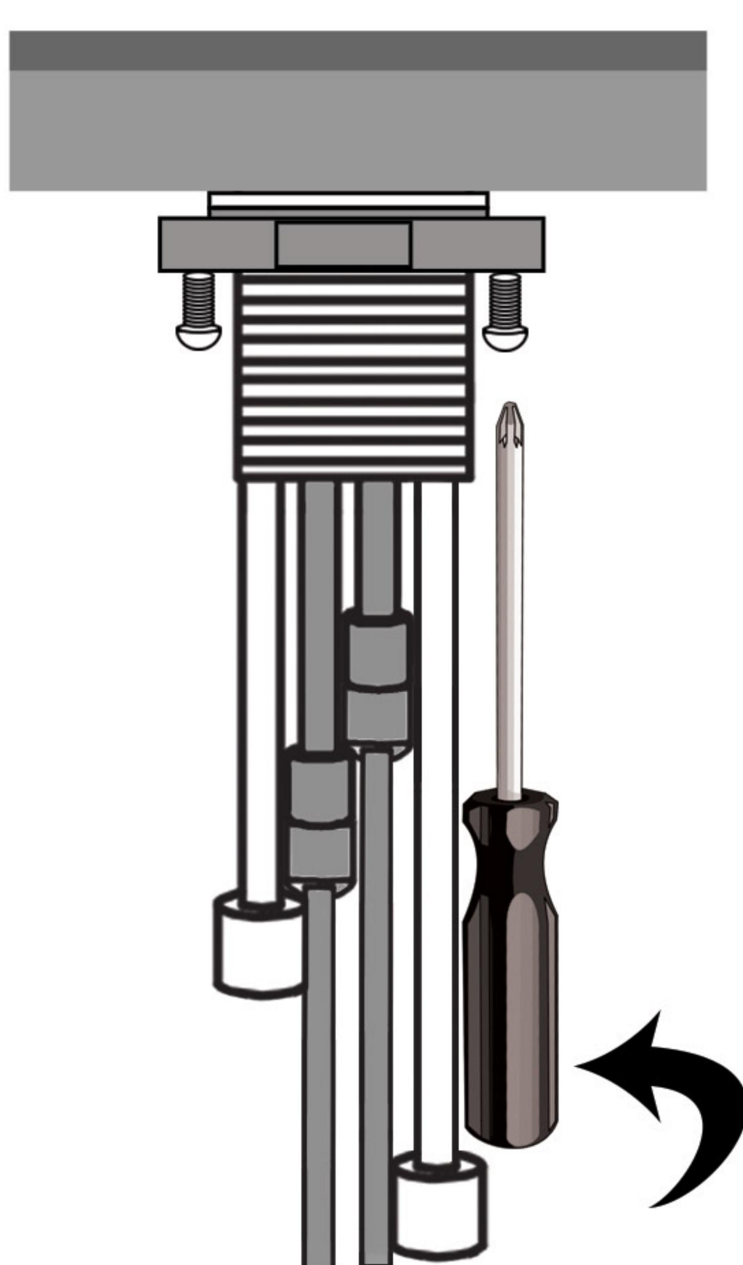
Serrez les vis de l'écrou de montage afin de le maintenir fermement et d'éviter que l'écrou prenne du jeu dans le temps.
