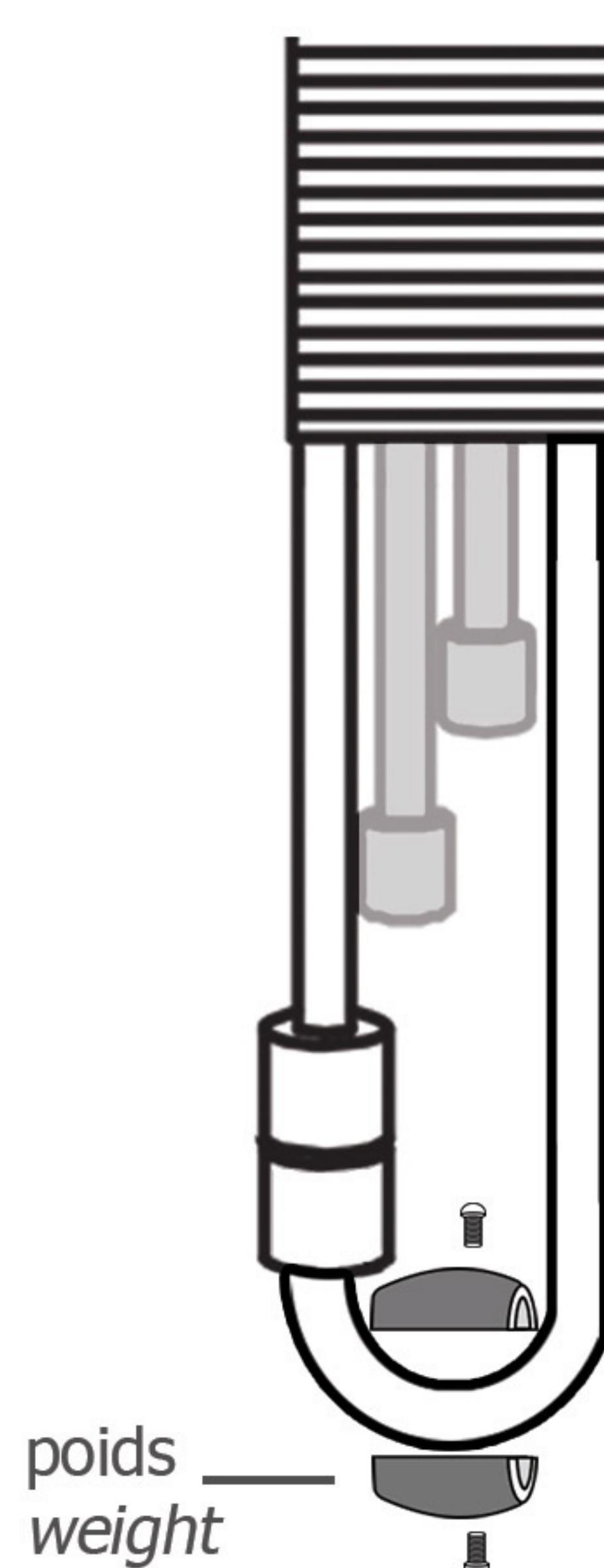
Installez le poids dans la courbe du tuyau flexible de la douchette. Serrez les vis et assurez-vous que le poids est bien maintenu.
