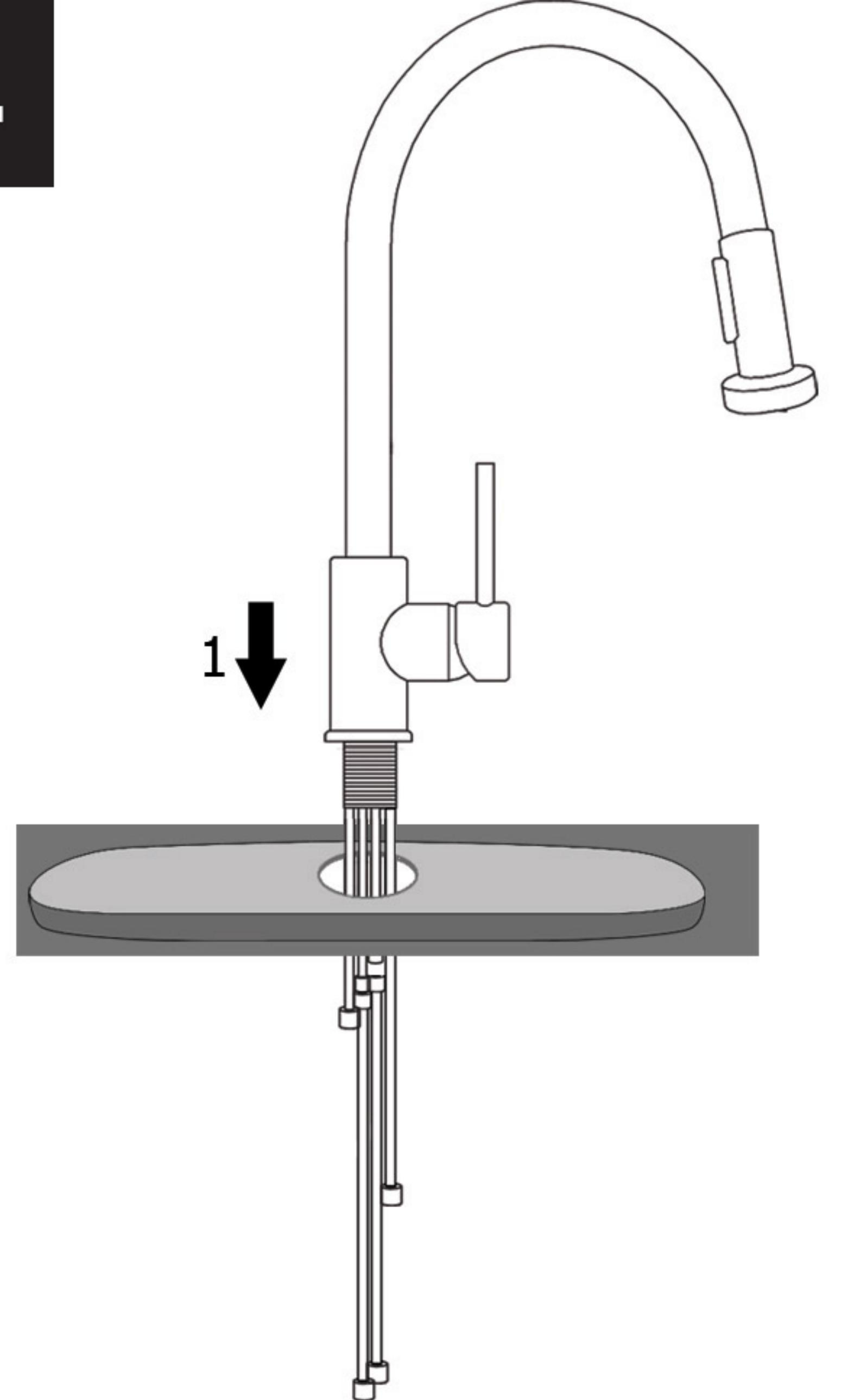
Positionnez le robinet en passant les tuyaux et le raccord d'accouplement par l'orifice de la plaque (si installée) et du comptoir ou de l'évier.
