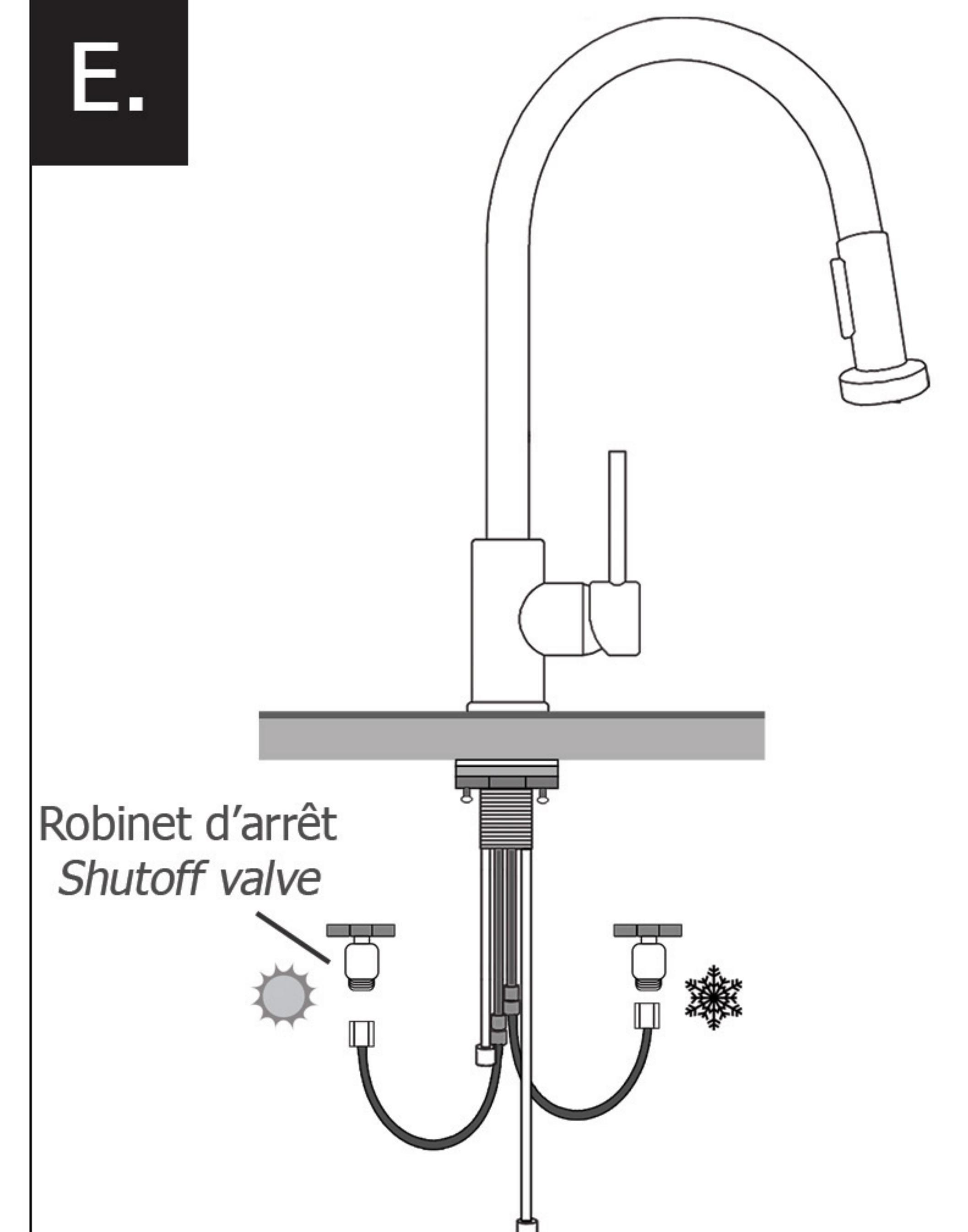
Raccordez les tuyaux flexibles d'eau chaude et d'eau froide (gris foncé) aux valves d'arrêt. Serrez manuellement puis utilisez une clé à molette.
