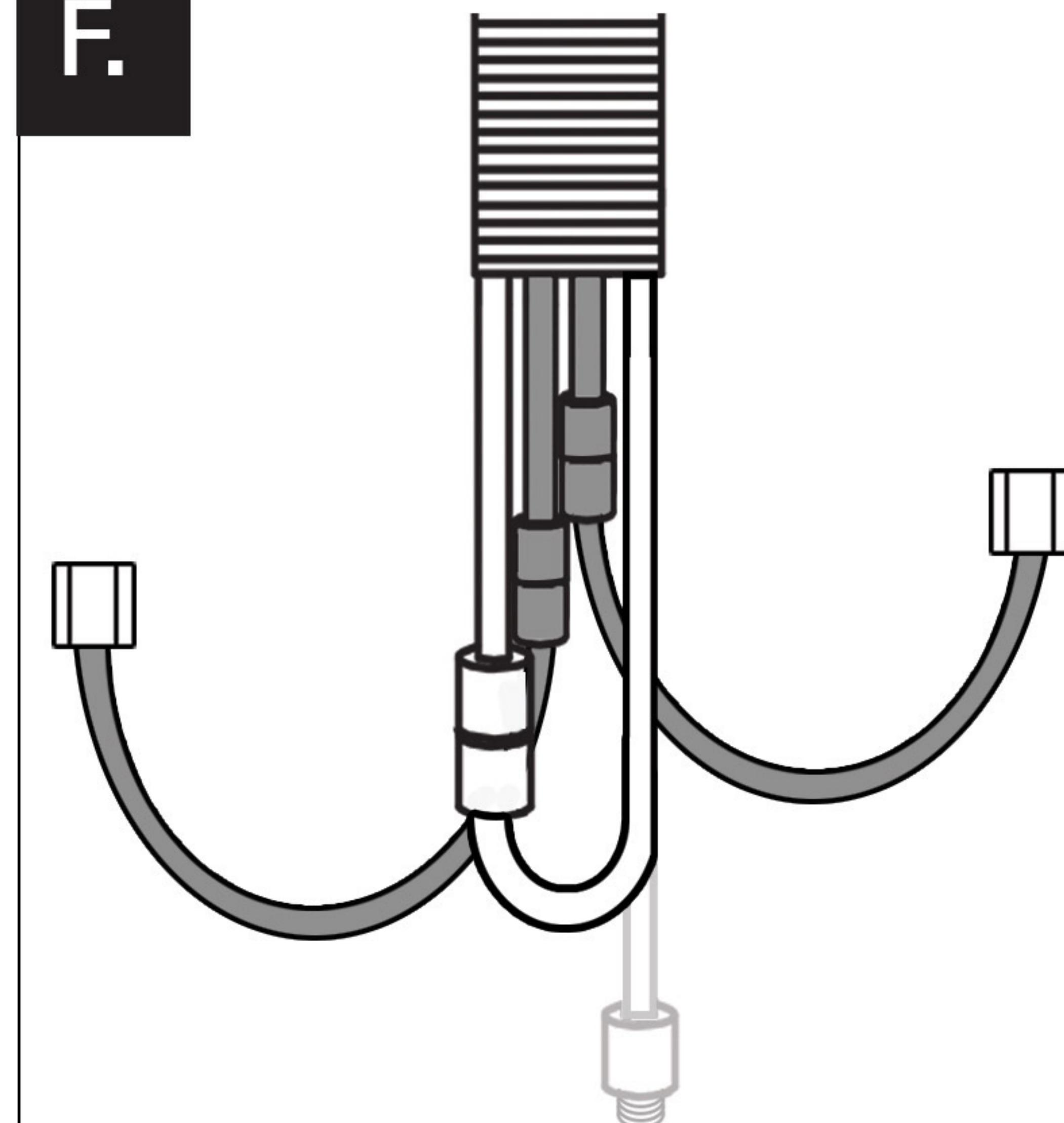
Connectez les deux (2) tuyaux flexibles (blanc) de la douchette pour fermer le circuit d'eau. Enclenchez les connections mâle et femelle manuellement.
