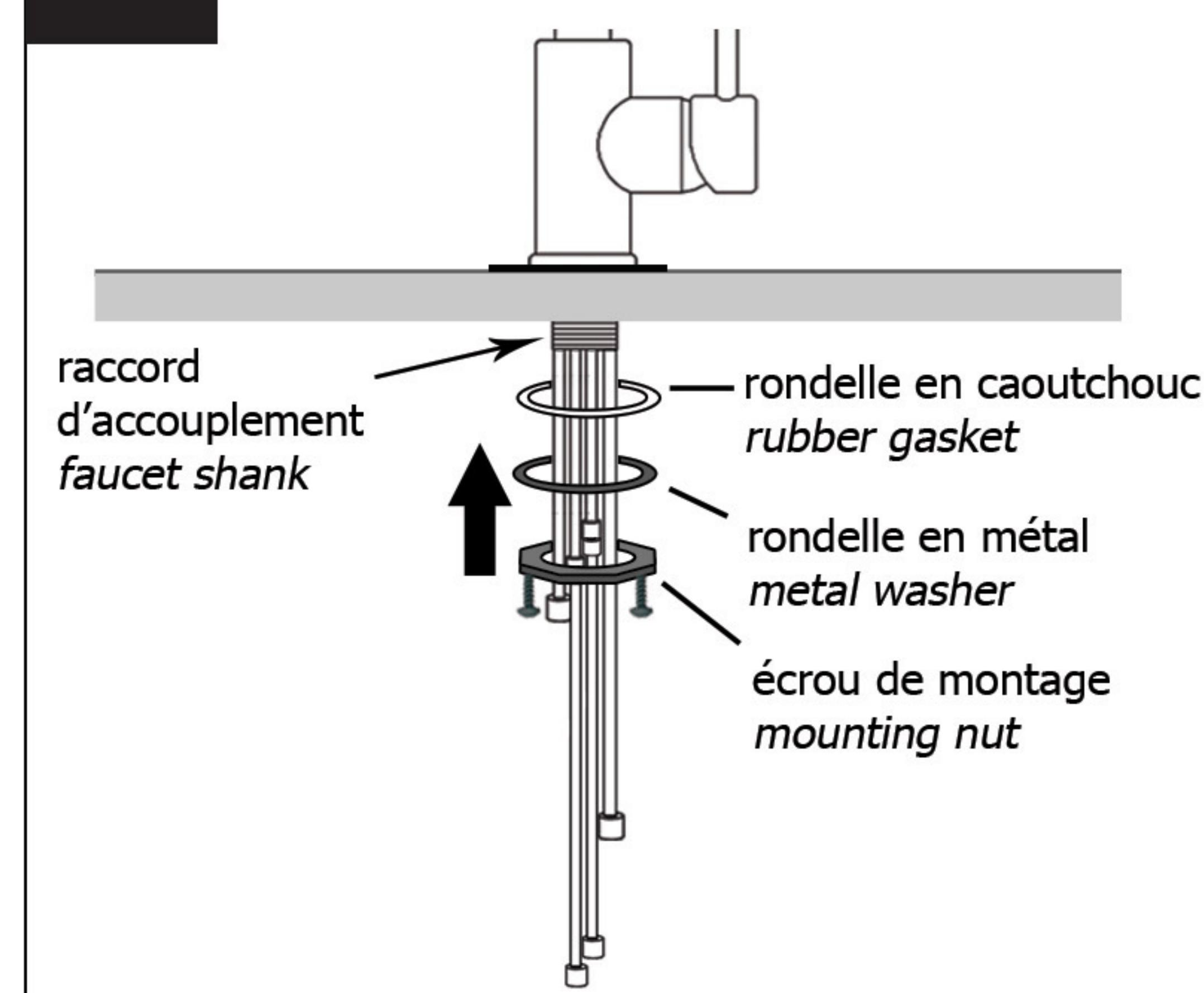
Monter le joint en caoutchouc, puis la rondelle en métal suivie de l'écrou de montage au raccord d'accouplement. Vissez manuellement l'écrou de montage au raccord. Assurez-vous que le robinet et l'écrou soient bien fixés, puis serrez l'écrou à l'aide de la clé à molette.
