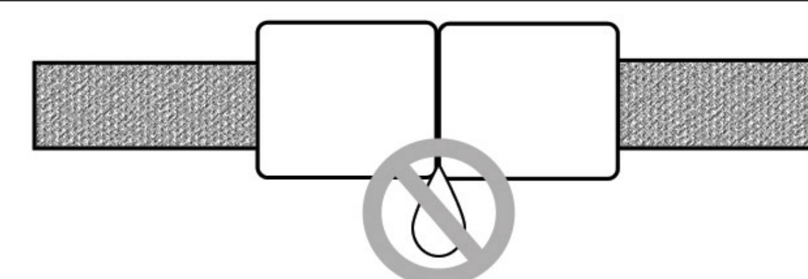
Il est maintenant temps d'alimenter le système en eau. Ouvrez les valves d'arrêt et le robinet de cuisine. Vérifiez toutes les connections pour détecter quelque fuite. En cas de fuite d'eau, vérifiez que la connection soit bien serrée.
