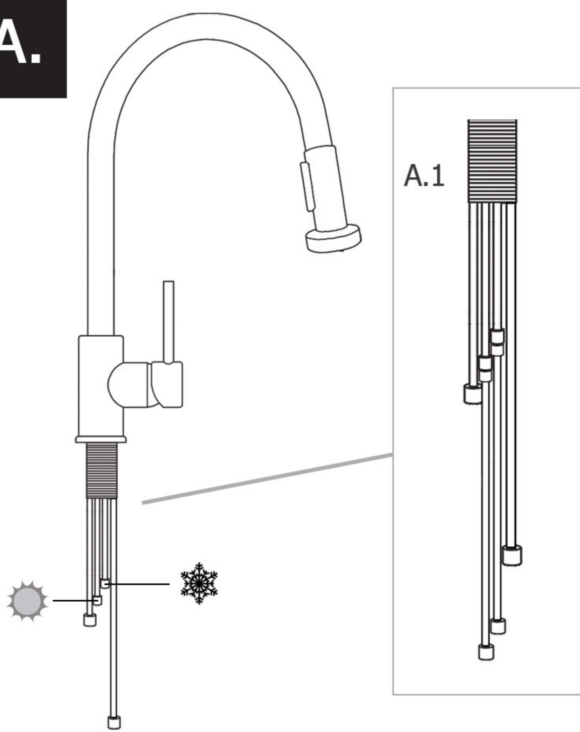
Raccordez manuellement les tuyaux flexibles d'eau chaude et d'eau froide au robinet, puis complétez le serrage à l'aide d'une clé à molette.
